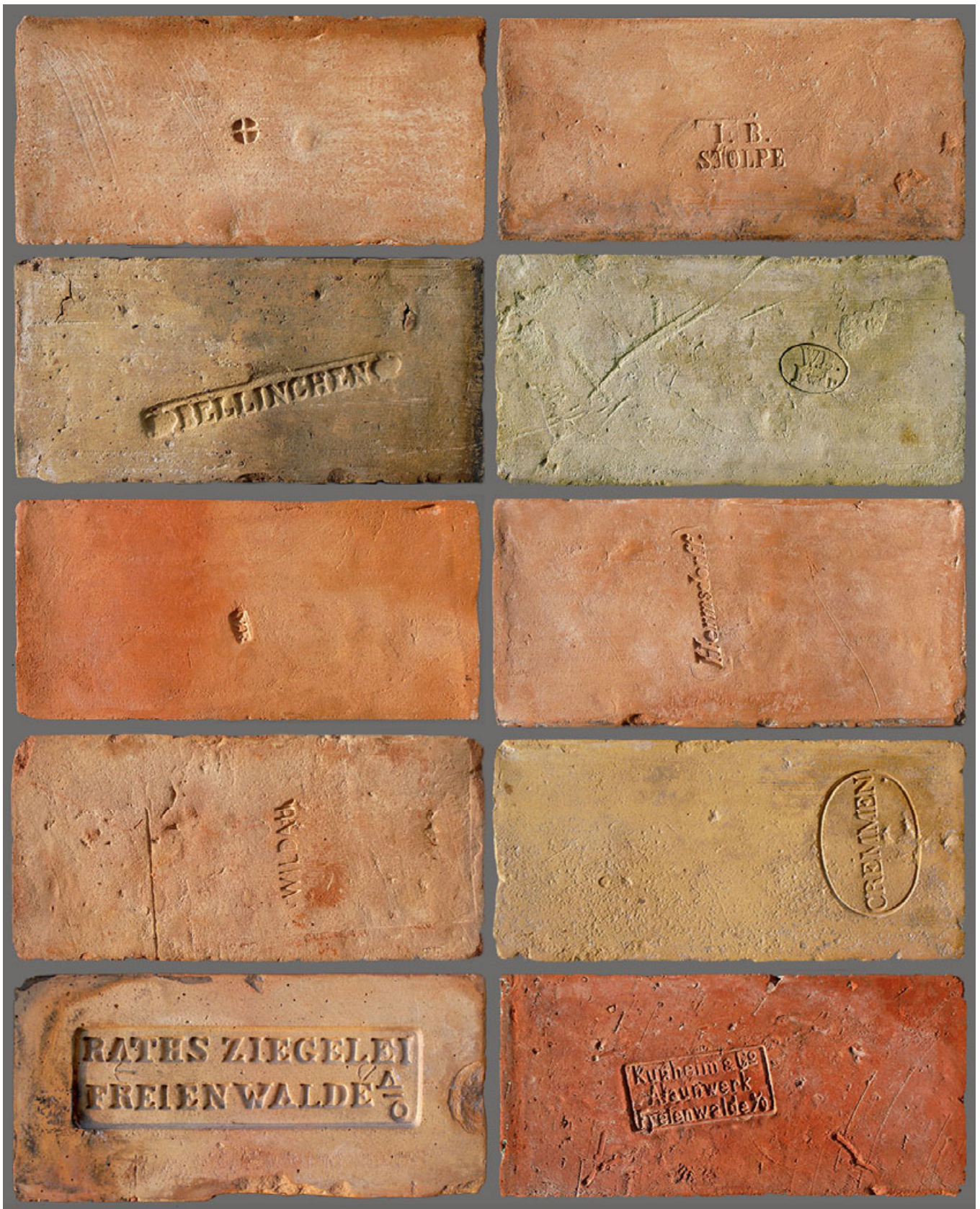
Abbildung oberhalb: Die in Berlin von 1824-75 gebräuchlichen Voll-Verblendziegel:
